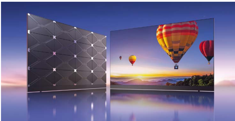
Bei 108 oder 110 Zoll Bildschirmdiagonale werden 16 dvLED-Module verbaut (hier: E-Serie).
